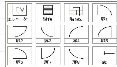
作成した図形を“部品”として登録出来ます。施工・作図の際によく使う図形を登録することにより、作図の時間短縮が図れます。
