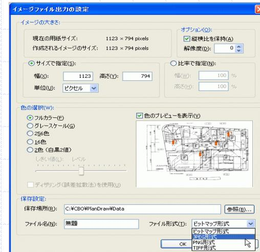
作成した配置図は、BMP形式、TIFF形式、PNG形式、JPEG形式の各画像ファイルに変換保存ができます。よって、作成した配置図を、どのパソコンからでも閲覧することができますようになります。
